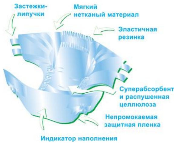
Рисунок Ж.2 – Общая схема устройства подгузника (а), в сечении (б)
